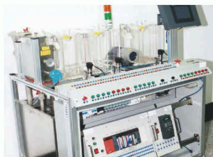
工业自动化过程控制及液料配方实训装置 专利证书号：第2479666号 专利号：ZL 2012 2 0169937.8
